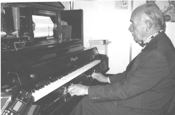
Spreker in de weer met een Ibach-pianola, waarin bovenaan een rollenmechaniek, op de toetsen van een QRS-Playola "opzetter" en onder zijn handen diverse knoppen om de weergave te beïnvloeden. Links een koppeling met orkestmuziek op een diskettespeler.
